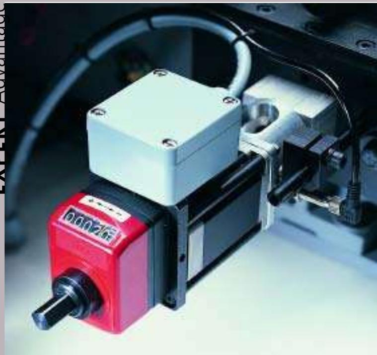
Programmgesteuerte Verstellungen durch Achsmotore
